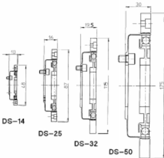
Figure 6. „Super-Flat“ component set design
