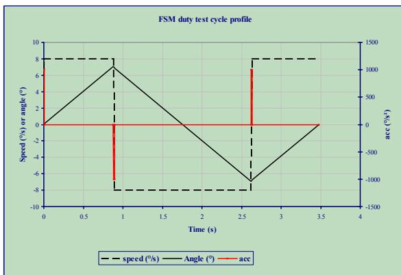
Fig. 3.- Fatigue duty cycle.
