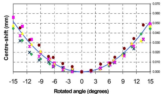
Fig. 13. - Custom 455 pivots centre shift.
