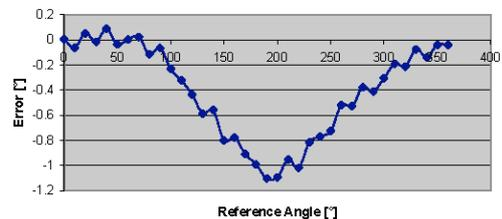
Figure 20. Sensor v6.8 output error
