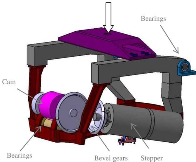
Figure 2.- Initial Baseline: Stepper+Gears+Cam
