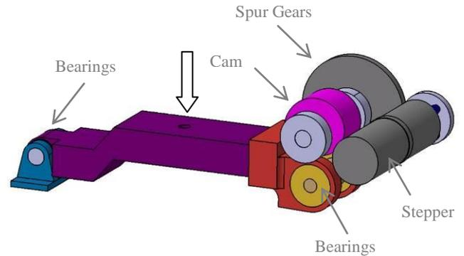
Figure 3.- Optimize Stepper+Gears+Cam
